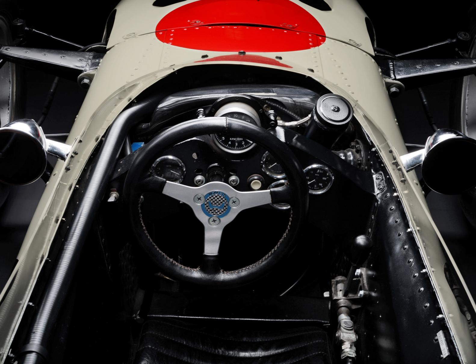
Bien qu'inexpérimentés en sport automobile, les ingénieurs Honda ont conçu un châssis monocoque pour recevoir leur moteur inspiré par la moto.
